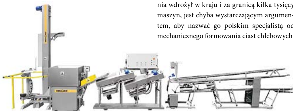
Dzielarki do chleba rzadko są wykorzystywane w piekarniach jako samodzielne maszyny. Zazwyczaj stanowią element całych linii do chleba (na zdjęciu linia sześcioprocusowa m.in. z dzielarką, zaokrąglarką czterotaśmową kaskadową, odprężnikami, wydłużarką walcową z klinem i stołem odbierającym). FOT. FIRMA WIECZOREK
